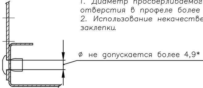
3. При заклепывании необходимо по возможности держать инструмент (заклепочник) строго перпендикулярно стыкуемой поверхности. В противном случае заклепка притягивается к плоскости под углом, что приводит к некачественному соединению деталей.
